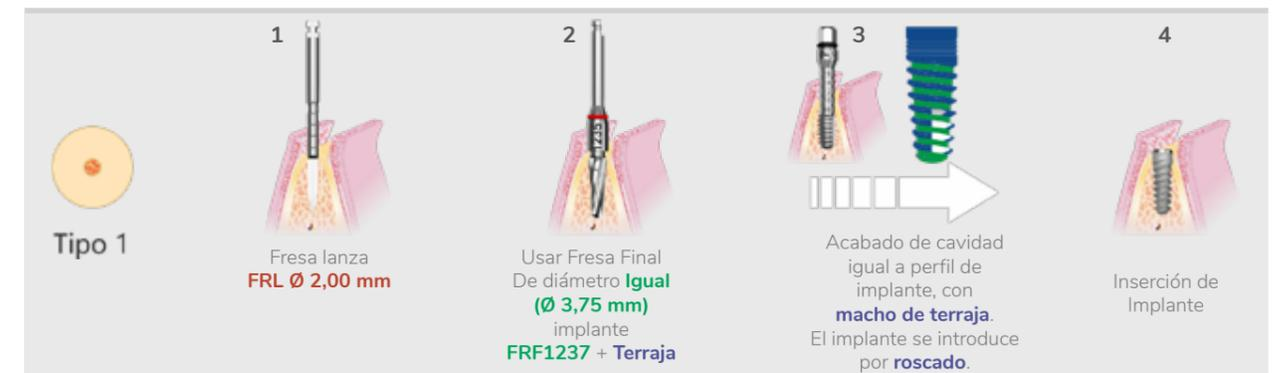
La secuencia de fresado, es demostrada en este ejemplo con fresa final de longitud 12 mm.
